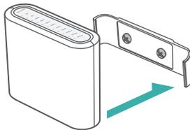
取付用ネジでブラケットを壁面に固定し、本体を取り付けます。カチッと鳴るまで押し込んでください。
